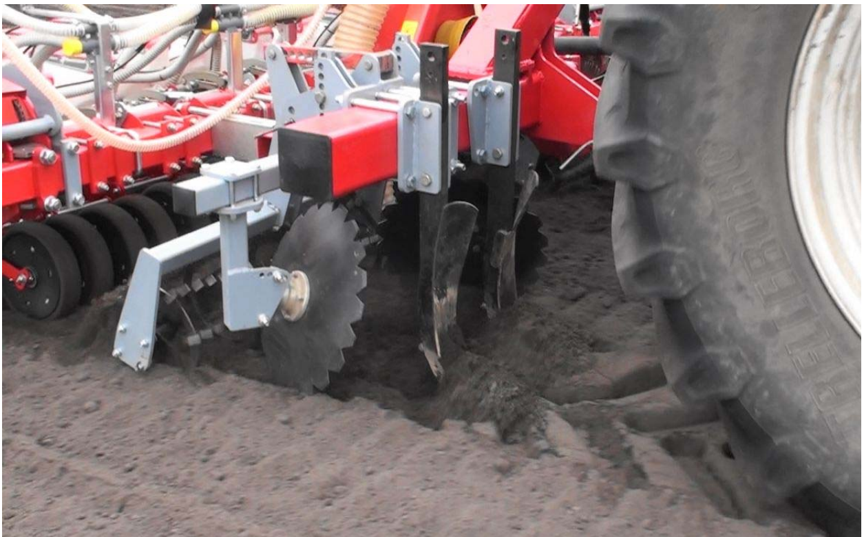
Siew nasion cebuli uprawianej w technologii bezzagonowej - uprawa gleby ugniecionej kołami ciągnika przed wysiewem nasion.
