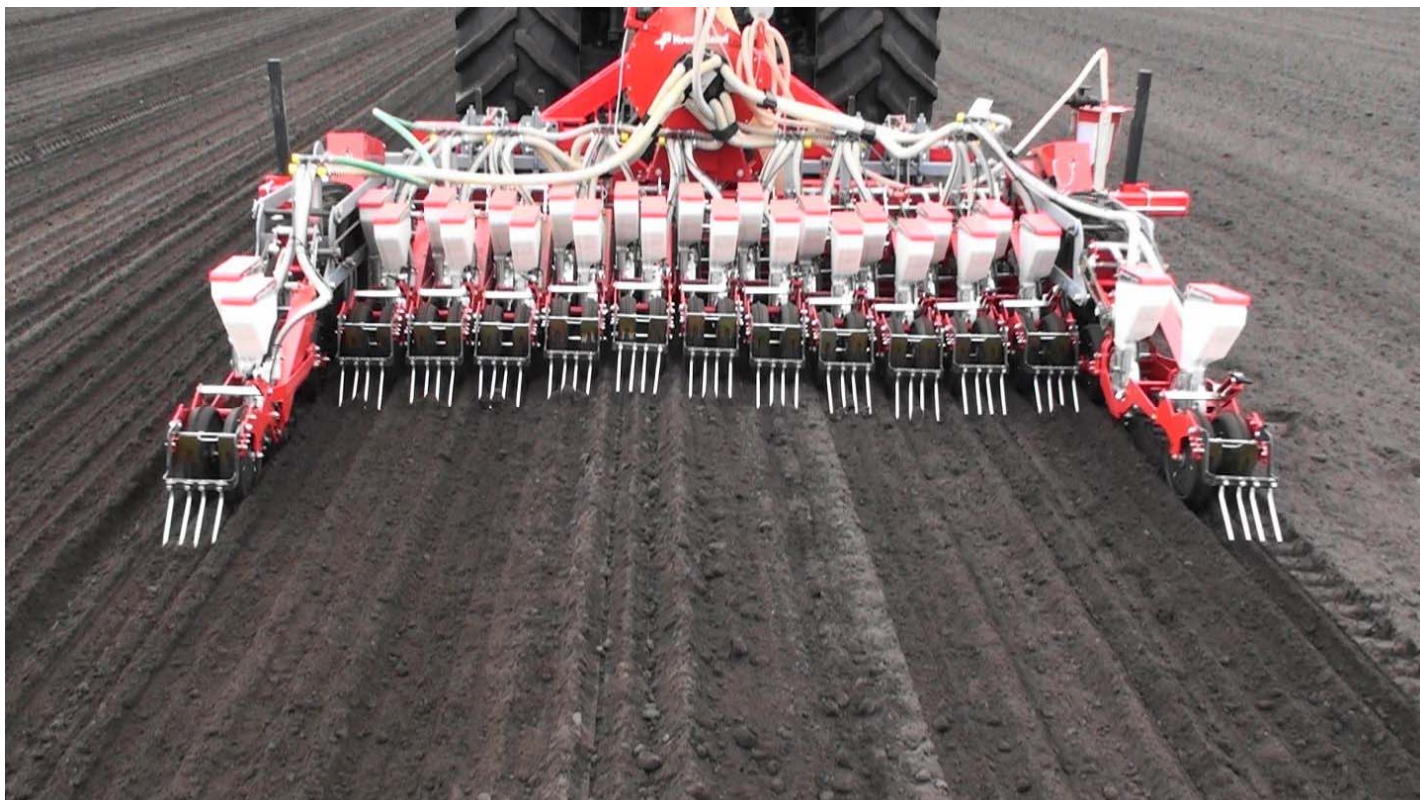
Widok siewnika po modernizacji o rozstawie rzędów (najmniejszym) 12,0 cm - zasiana powierzchnia gleby nasionami cebuli w technologii bezzagonowej, zarówno za kołami ciągnika jak i za kołami zmodernizowanego siewnika.
