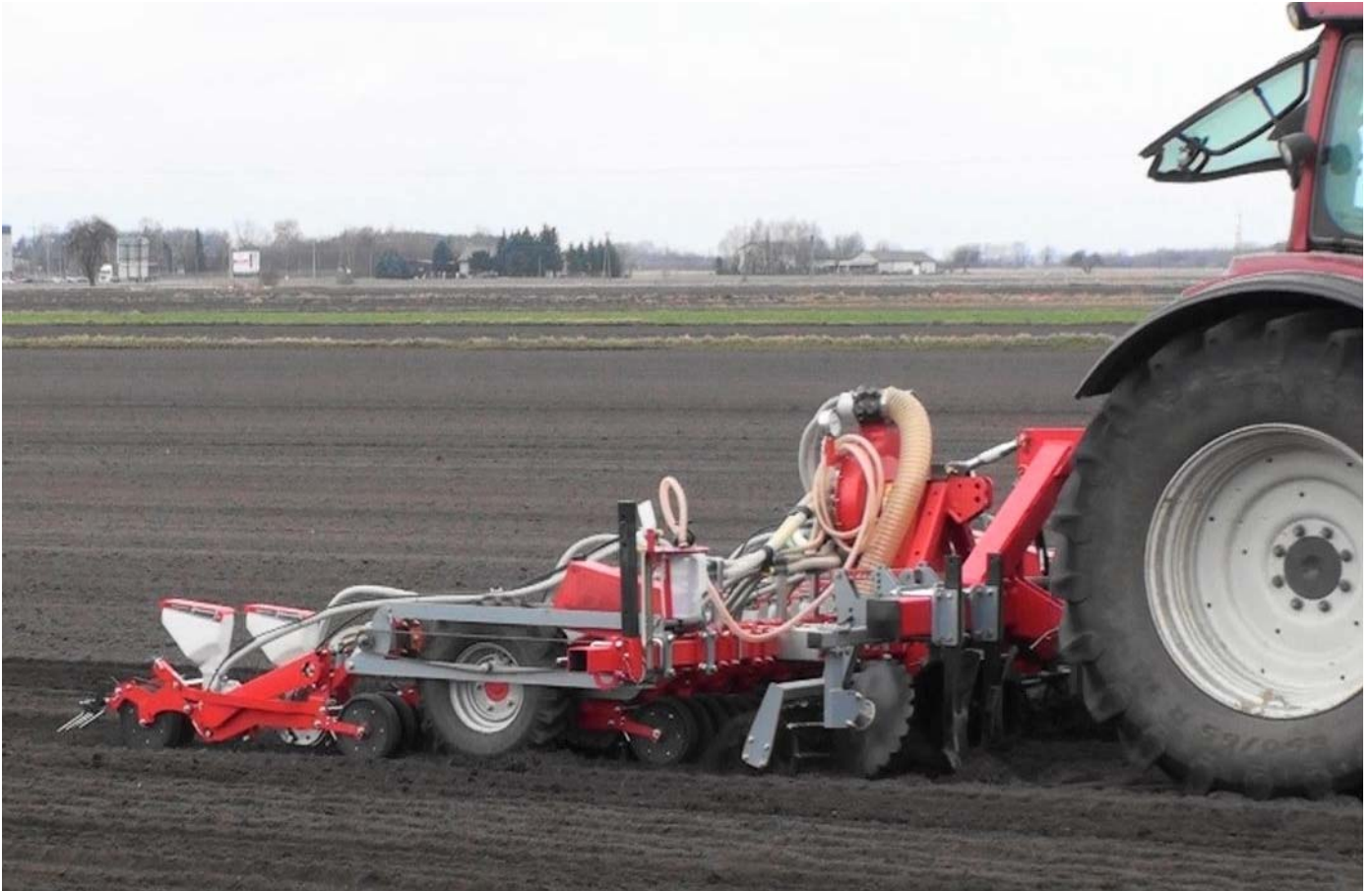
Widok tego siewnika z boku - sekcje pracujące za kołami siewnika unoszone i składane do transportu.
